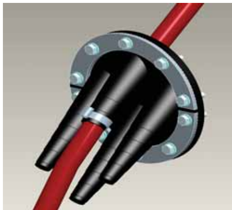
Plugs de acometida de cables en neopreno con reducción progresiva del diámetro que facilita el ruteo de cables MT y BT (vista interior dentro del centro).
